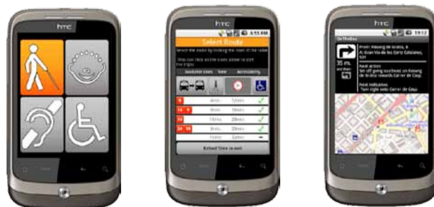
Drei Beispiel-Bildschirme von OnTheBus: links - Die Auswahl des Nutzungsprofils; Mitte - Vorgeschlagene Routen; rechts - Wegführung
