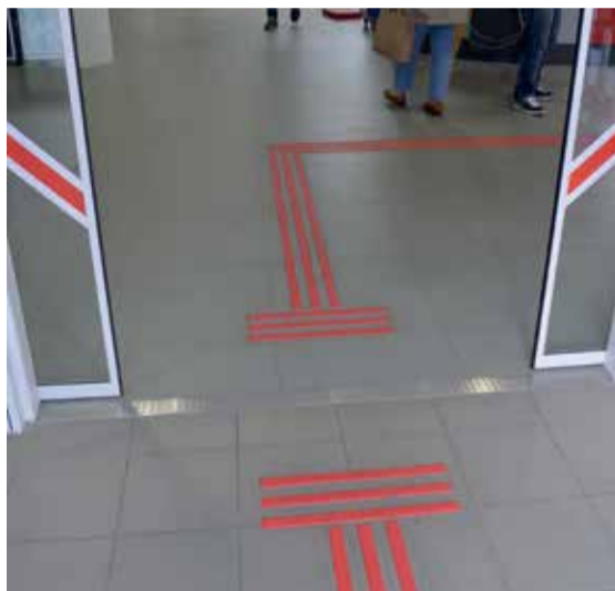
Das taktile Bodenleitsystem führt direkt zum richtigen barrierefreien Schalter.
