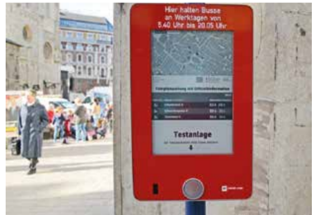
Testbetrieb an der Bushaltestelle Stephansplatz: E-Paper ist elektronischer Fahrplanaushang und Echtzeitinformation Foto: next urban technologies GmbH, www.nexturban.at
